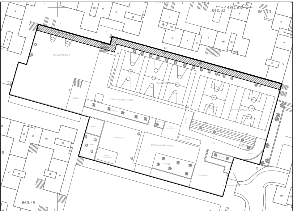
VACIADO 3 m DE ANCHO PARA MURO ENCOFRADO A 2 CARAS
